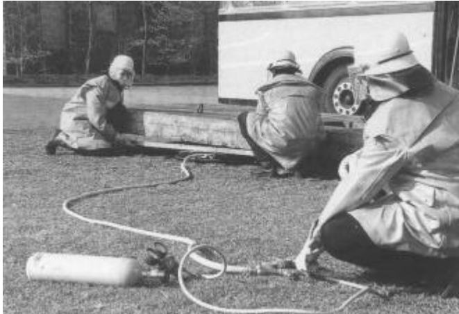
Instellungbringen eines Druckkissens mit Holzauflage
